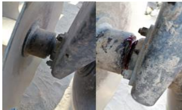
Figura 10 engrase de los rodamientos
